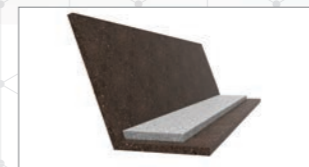
기초 콘크리트 타설
