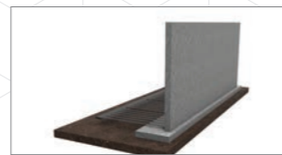
벽체 콘크리트 타설
